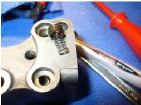
...und eine Kugel. Diese sollte, wie hier, sich nicht in der Feder befinden, denn dies ist meistens dann der „Defekt“ für das Ablaufen des Oeltanks. Also kontrollieren, ob die Kugel mit Durchmesser von 5,5 mm in die Feder schlupfen kann. Falls ja, Kugelschreiber haben solche Federn, die kann man kürzen und verwenden.
