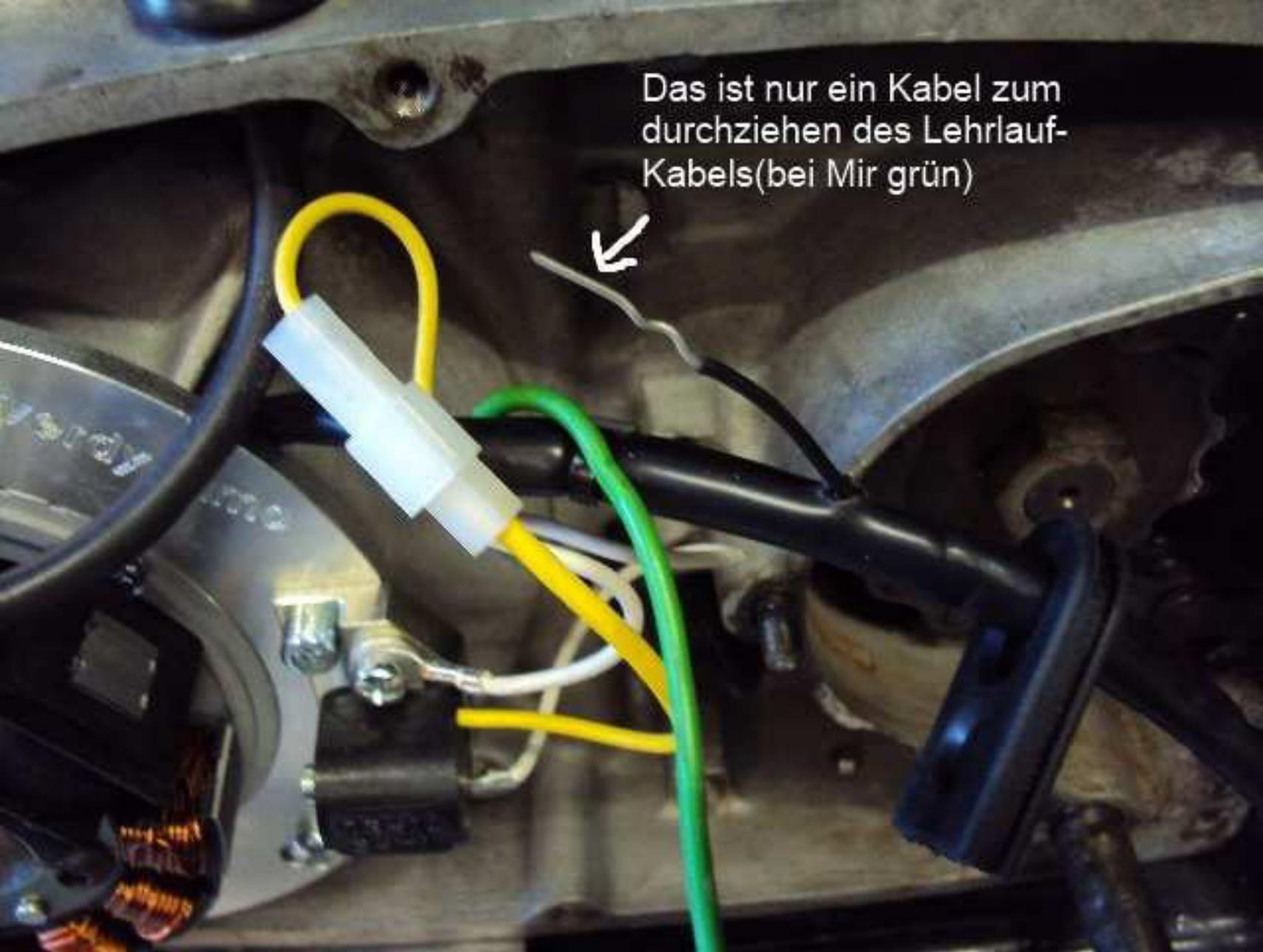
Schlecht zu erkennen ist aber die Durchführungsbohrung für die Kabel im linken Motorenhäuser. Wenn man sich (wie Ich) entschieden hat, die Zündspule im Werkzeugkasten unterzubringen, ist es erforderlich diese Öffnung (wegen der Zündkabel) zu vergrößern!
