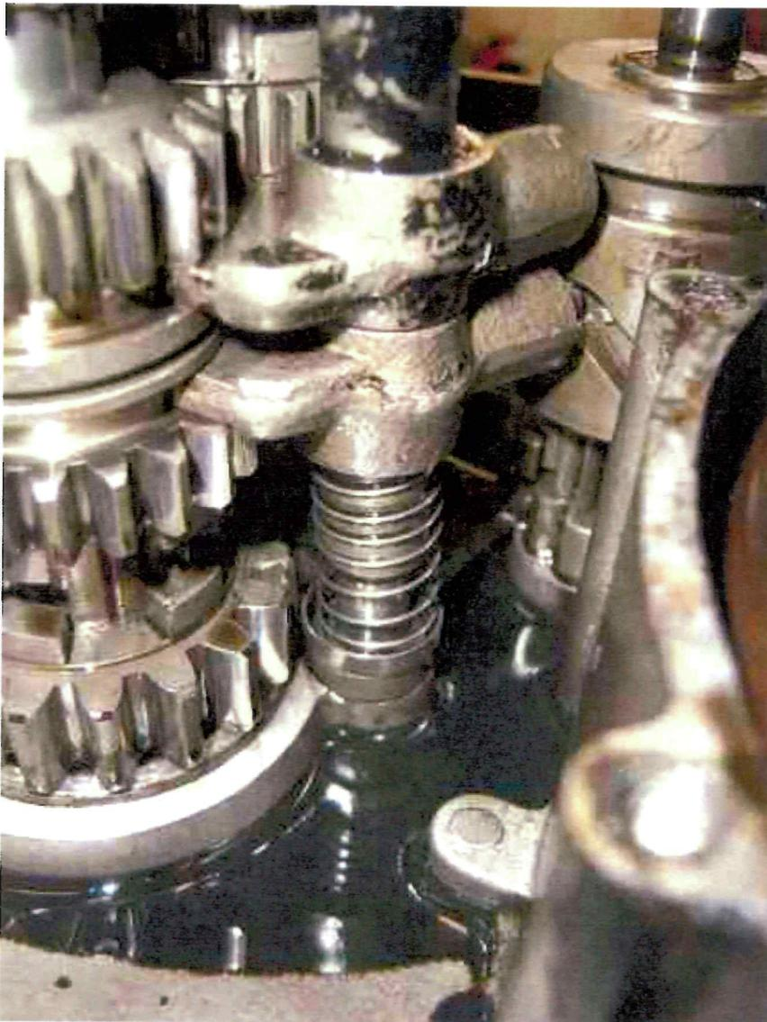
Über das Zahnrad-Segment bewegt der Schalthebel die Schaltwalze.
