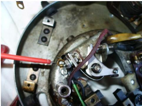
Gelber Draht an der Minus-Kohle (Masseverbindung) suchen. Der Draht geht nach hinten in die Feldwicklung, aus der auch das DF- Kabel kommt, das zum Regler geht.
