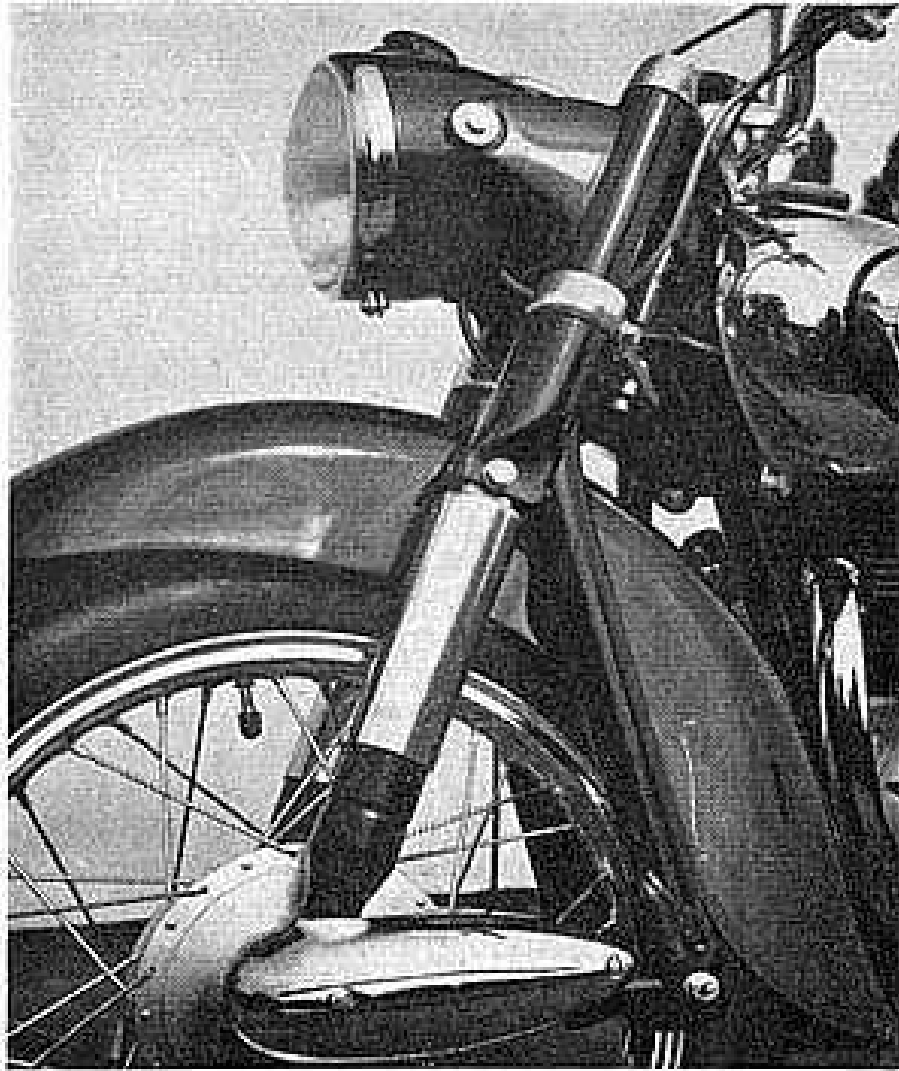
Die Fahrbahnstöße werden durch zwei wartungsfreie, mit hydraulischer Stoßdämpfung ausgestattete Feder-elemente elastisch aufgenommen.
