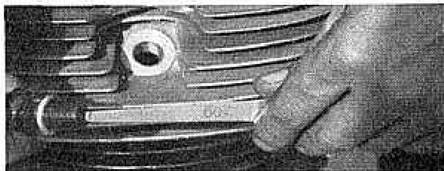
Elektrodenabstand mit Fühllehre kontrollieren
